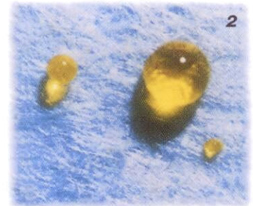
Fig. 2 - Effetto idrorepellente su un feltro di poliestere.
